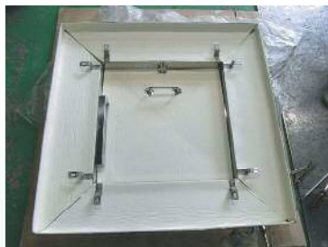
結露防止でべフ貼付
