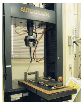
↑ 滑車引っ張り試験中
