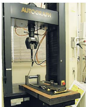
↑ 滑車引っ張り試験中
