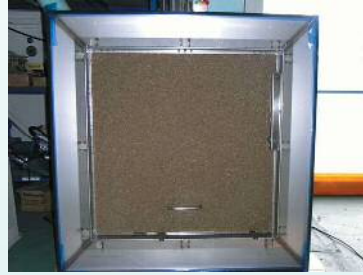
結露防止でグライト吹付け
