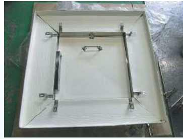
結露防止でべフ貼付
